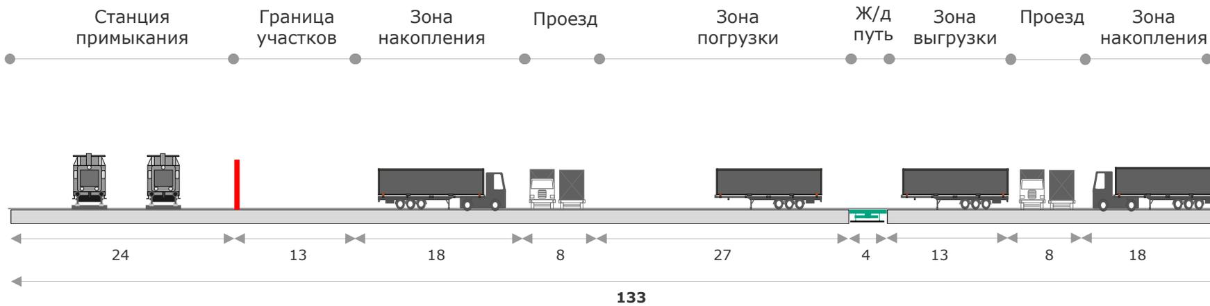
Рис. 6.9. Поперечное сечение контейнерного терминала.
