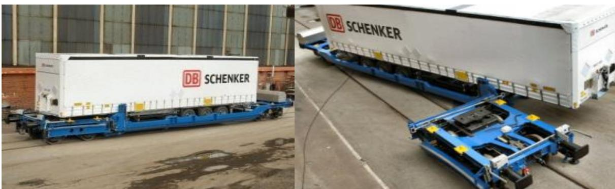
Рис. 2.8. Терминал MegaSwing.
