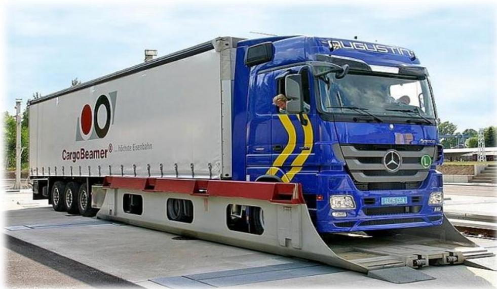
Рис. 2.4. Передвижная часть платформы (поддон) CargoBeamer.
