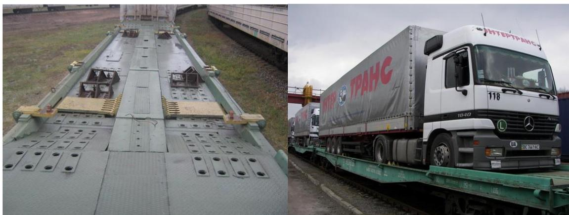
Рис. 2.22. Технология контрейлерных перевозок.
