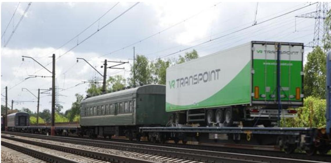
Рис. 5.3. Платформы Sdggñqss-w с вагонами прикрытия в составе опытного поезда.
