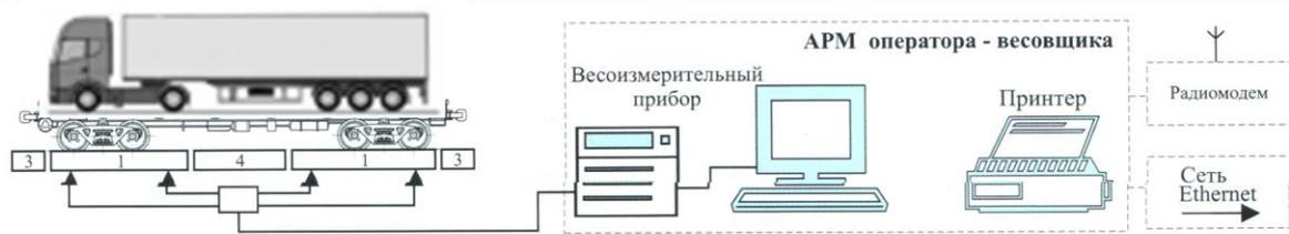
Рис. 6.18. Схема организации весоизмерения.
