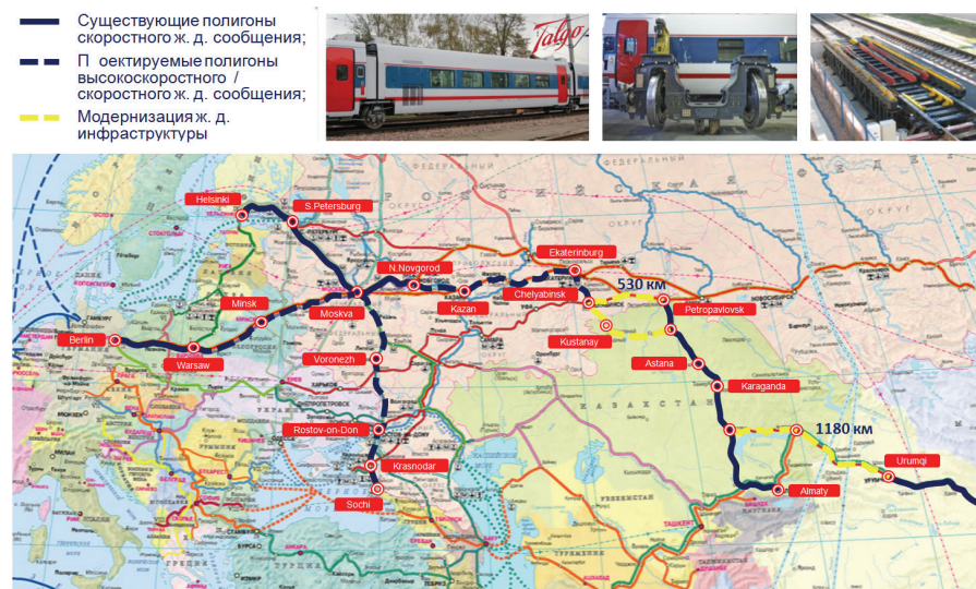
Рис. 9. Топология полигона скоростного железнодорожного грузового сообщения на базе адаптации «пассажирских» технологий с изменяемой шириной колеи
