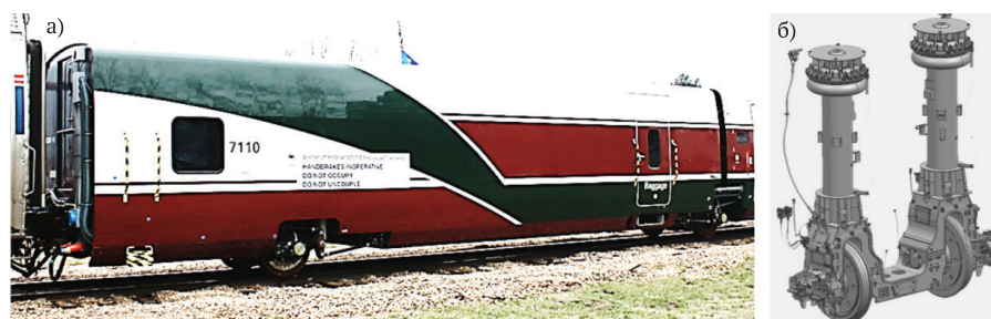
Рис. 8. Багажный вагон Talgo (а) и его колесная пара (б)
