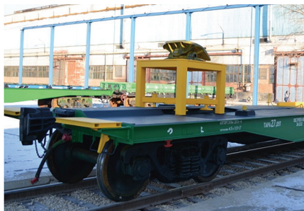
Рис. 4. Средство крепления для вагона 13-9938
