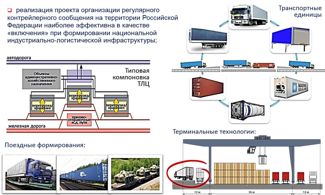
Рис. 13. Технологические и компоновочные решения интермодального терминала.
